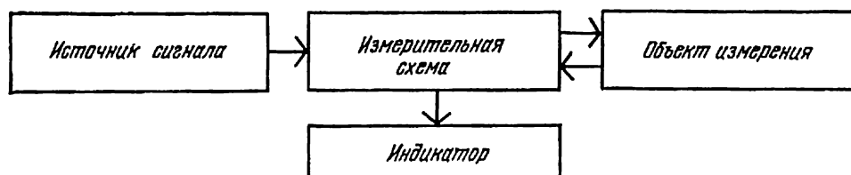
Рис. 1.3. Обобщенная схема приборов для измерения характеристик и параметров многополюсников.
